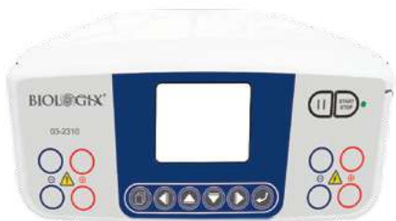
可同时提供 4 组电极输出
